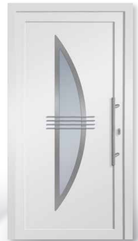
M-153 Ansicht A / DIN rechts Rahmen in Edelstahloptik beidseitig, Edelstahlrundstäbe außen ■ Isolierglas Satinato weiß | GG 2 ■ Griff ZAE 6s, 600 mm | PG 6
