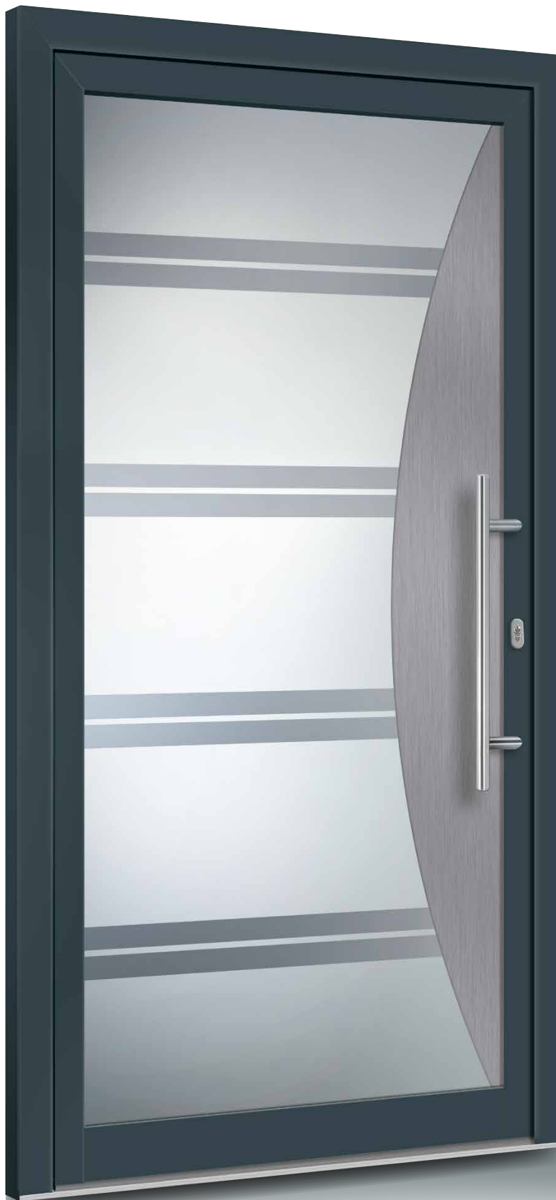
V-473 Ansicht A / DIN rechts G Ganzglasfüllung 3-fach Glas, Ug 1,7 bei 28 mm und Ug 1,1 bei 36 mm bogenförmige Applikation in Edelstahloptik, helle Flächen mattiert, dunkle Streifen Klarglas ■ Griff ZAE 6s, 600 mm | PG 6
